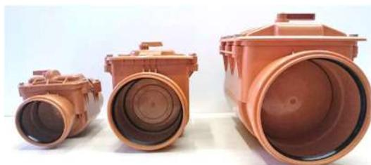
VOCE DI CAPITOLATO : Fornitura di valvola antiriflusso di linea con sistema di chiusura di emergenza (fino al DN315) costruita in PVC, metallerie in acciaio inox , per innesto su tubi in PVC o per accoppiamento su tubi di qualsiasi materiale ( PVC, PEAD, PRFV, gres, ghisa, fibrocemento, etc ) per mezzo di giunti multidiametrali ; tappo di ispezione e pulizia ; guarnizione di tenuta in EPDM
