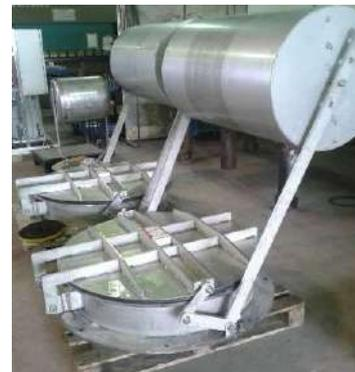
VOCE DI CAPITOLATO : fornitura di valvola antiriflusso a galleggiante in acciaio .....(AISI 304 – AISI 316 – acciaio zincato) a sezione circolare o rettangolare delle misure di ..... mm ; guarnizioni in EPDM ; le valvole devono essere costruite per impedire il riflusso dell'acqua a seguito dell'innalzamento del livello grazie alla spinta del liquido sul galleggiante
