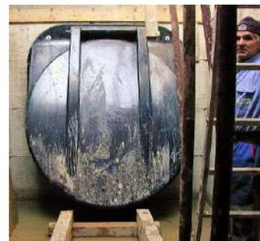
VOCE DI CAPITOLATO : Fornitura di valvola antiriflusso fine linea costruita in poliestere rinforzato e gel-cot isoaltico, metallerie in acciaio inox AISI 316 , flangiata per accoppiamento a parete verticale ; battente inclinato ; tenuta idraulica 1 bar ; guarnizione di tenuta in EPDM
