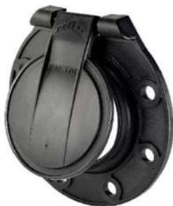
VOCE DI CAPITOLATO : Fornitura di valvola antiriflusso fine linea a battente verticale costruita in poliammide , per accoppiamento a parete verticale o a flangia forata PN10; tenuta idraulica 1 bar; guarnizione di tenuta in EPDM
